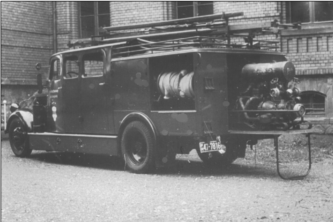
Löschgruppenfahrzeug LF 8 mit eingeschobener Tragkraftspritze TS 8/8 Das im Stadtgebiet 1945 aufgefundene und wieder instand gesetzte LF 8 ca. 1948 im Schulhof der Reitschule. Das Autokennzeichen FR steht für französisch besetzte Zone.
