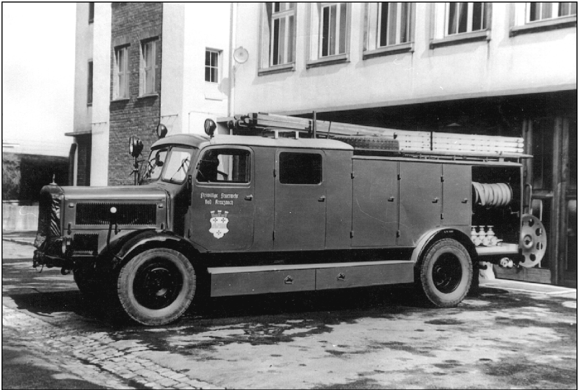
Löschgruppenfahrzeug LF 25, Spitzname: Jumbo. Fahrzeughersteller: Daimler-Benz, Besatzung 1/8, Pumpenleistung 2.500 l/min.
